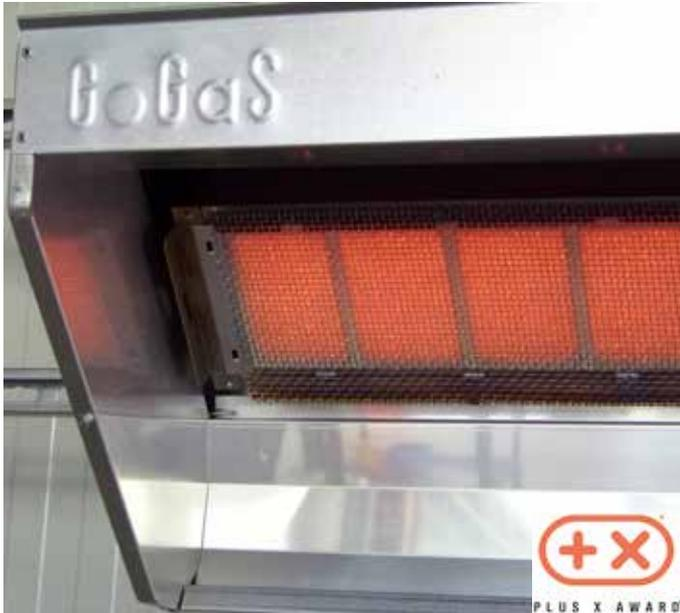
El corazón de todos los calentadores GoGas de alta intensidad es la cámara de combustión realizada en acero cromado resistente al calor y equipada con cerámica alemana de alta precisión y una superficie estructurada realmente extraordinaria. Esta estructura, que extiende la superficie de combustión, y los más de 900 poros extremadamente finos de cada placa cerámica, permiten alcanzar temperaturas en la superficie de 950°C y una energía térmica de 1500 vatios por placa cerámica.
